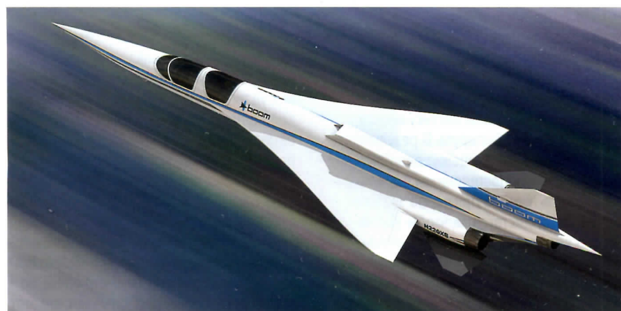
Трехдвигательный самолет-демонстратор XB-1 фирмы «Бум» рассчитан на значительно более высокую скорость полета, чем X-59 и QSTa
