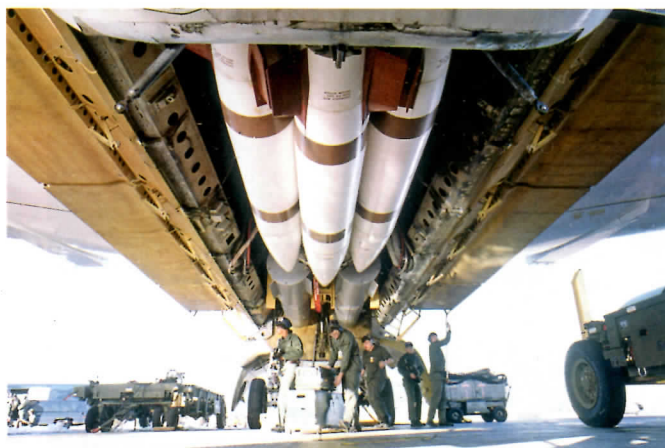
Полная внутренняя зарядка самолета В-52Н – 8 ракет AGM-69 и 4 термоядерные бомбы В28 (Фотом: http://defenseimagery.mil )
