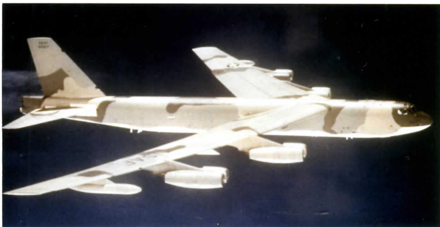
Проходя фазу I модернизации, самолеты В-52G и H получали и камуфляж. На фото В-52H-135-BW S/N 60-0017 с пилоном для блока AN/ALE-25 для НАР с дипольными отражателями
