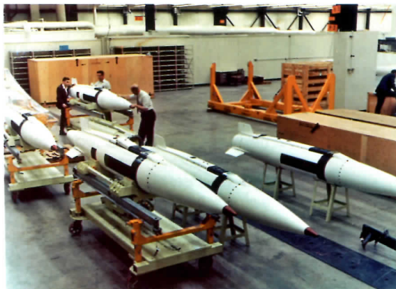
Серийное производство ракет AGM-69A SRAM на заводе фирмы «Боинг Аэроспейс» (Фото: http://forum.warport.ru/showthread.php?p=12703 )
