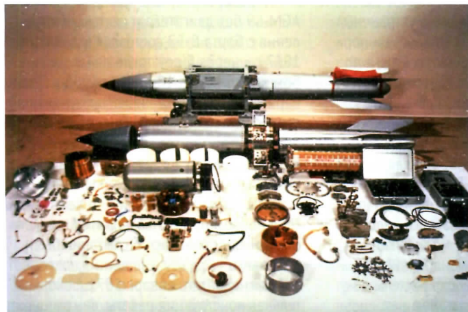
Вошедшая в ходе I фазы модернизации в состав вооружения стратегических бомбардировщиков В-52G/H термоядерная бомба В61-7, ее составные части и комплект ЗИП
