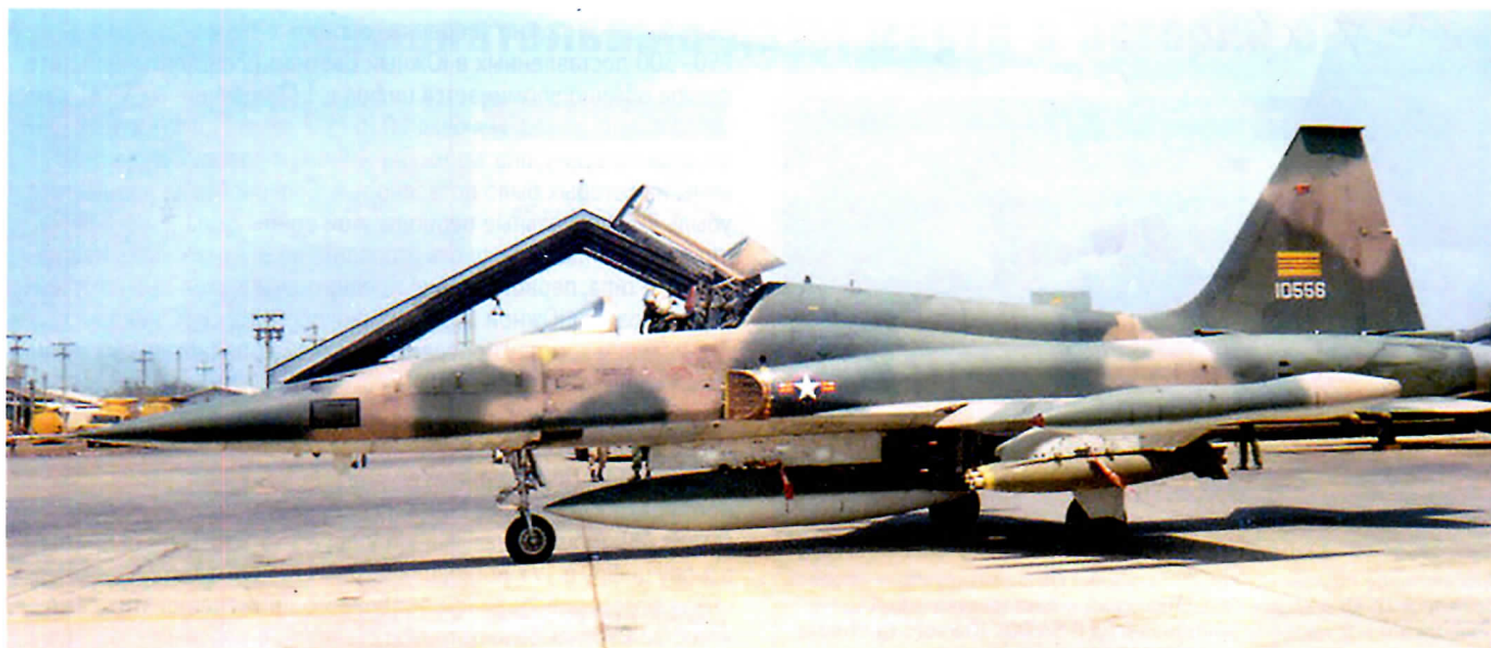
Южновьетнамский F-5A с подвешенными бомбами выруливает на взлетную полосу. В отличие от американских самолетов, он не оборудован штангой дозаправки топливом в полете
