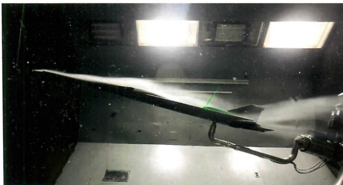
Испытания модели X-59 в аэродинамической трубе (Формо https://ic.pics.livejournal.com/phys_exp/20166967/53785/53785_original.jpg )
