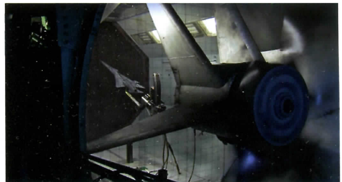
Испытания модели X-59 в аэродинамической трубе (Формо https://ic.pics.livejournal.com/phys_exp/20166967/53785/53785_original.jpg )
