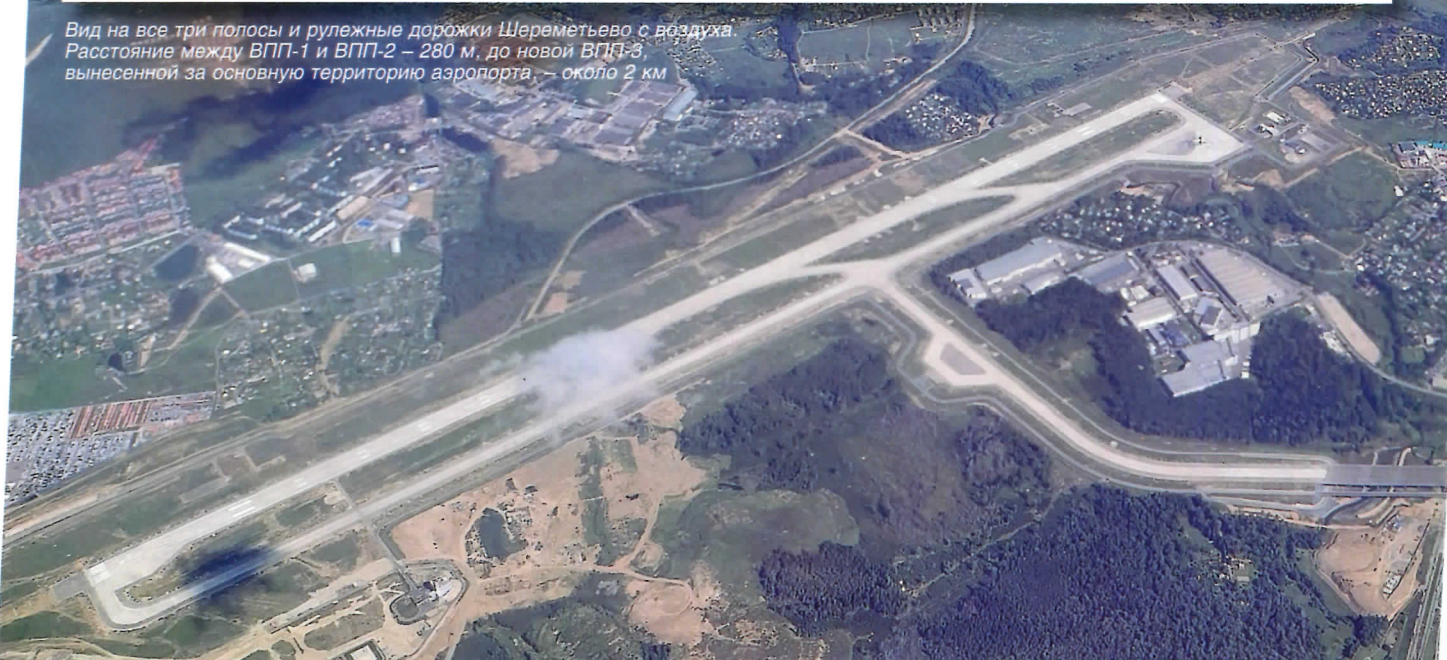
На новую шереметьевскую ВПП-3 самолеты с основной территории аэропорта попадают по рулежной дорожке, проходящей по специально возведенному мосту над Шереметьевским шоссе
