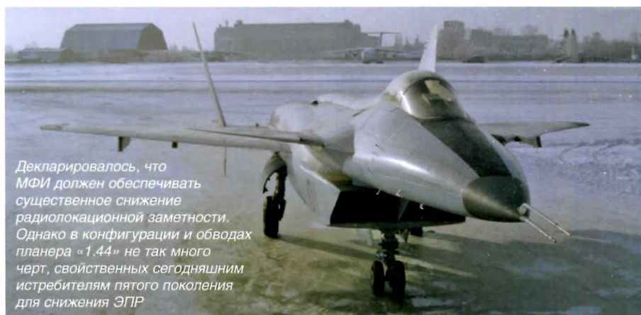
В состав силовой установки «1.44» вошли опытные двигатели пятого поколения АЛ-41Ф
