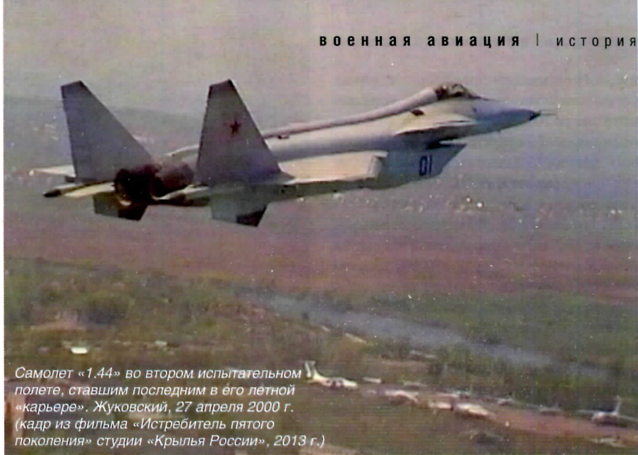
Во втором полете «1.44» была проверена работа ряда систем, в частности, уборка и выпуск шасси (кадр из фильма «Истребитель пятого поколения» студии «Крылья России», 2013 г.)
